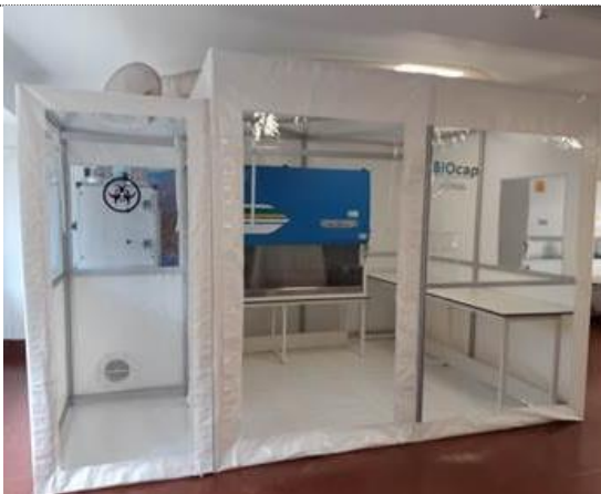
Protótipo da Biocap em pressão positiva (proteção do interior face à envolvente)
